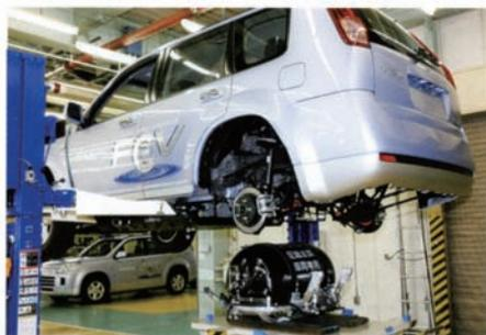
「X-TRAIL FCV」2005年モデルを開発。自社製の燃料電池スタック (発電装置) を従来より60%小型化し、さらに燃料となる水素ガスを70Mpaで貯蔵できる高圧水素容器を搭載しています。
